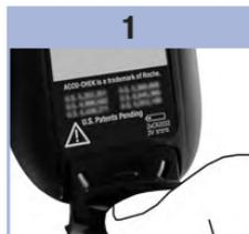
Большим пальцем выдвиньте отсек для батареек из глюкометра.
